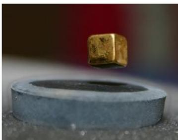
*lévitation magnétique d'une céramique supraconductrice sur un aimant baignant dans de l'azote liquide*
