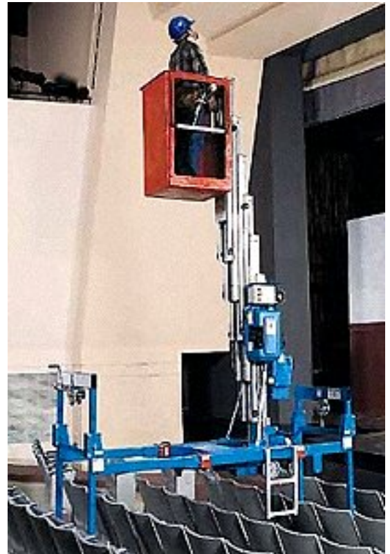
Illustration IV-20 Nacelle équipé d'une embase surelevée (Doc Genie Industrie - 23 Ko)
