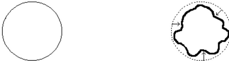
*Pour garder une surface constante lorsqu'elle est déformée, une forme sphérique doit nécessairement rétrécir le volume global qu'elle occupe*
