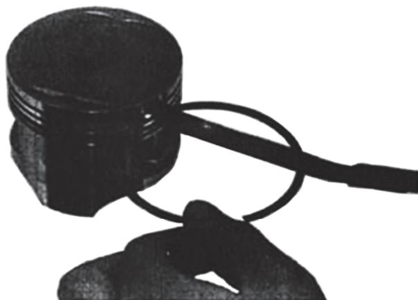
A l'aide d'un piston, enfoncer le segment perpendiculairement dans le cylindre et en mesurer la coupe.
