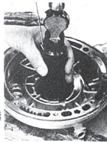
ACCESSOIRE DE CHASSOIR DE 32x35 mm 07746 - 0010100 ET GUIDE DE 20 mm 07746 - 0040500
