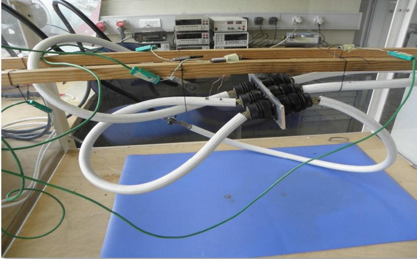
Montage permettant de réaliser les tests d'échauffement sur différents types de connecteurs
