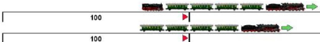
En utilisant cette formule, un train peut être coupé avec un dételeur situé à 100 cm/pouces devant les deux derniers véhicules sans se préoccuper de savoir si ces véhicules sont des mocomotives ou des wagons.
