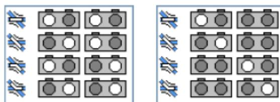
**Figure 71 : configurations du décodeur pour une TJD**
