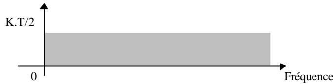
Figure 2. Densité spectrale de la puissance de bruit
