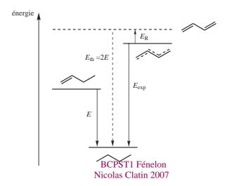
On appelle **énergie de résonance**  $E_{\rm R}$  la différence entre et l'énergie de la forme limite la plus probable de la molécule et l'énergie de la molécule réelle. Dans le cas du but-1,3-diène, elle vaut :  $E_{\rm R} = E_{\rm th} - E_{\rm exp} = 15~{\rm kJ\cdot mol}^{-1}$ .
