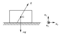
Puisque le solide est au repos, la vitesse de son centre de gravité est nulle. On en déduit une relation entre les forces extérieures appliquées, qui sont le poids d'une part et la réaction du support d'autre part :
