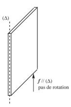
Appliquons maintenant la force dans un plan perperdiculaire at axe de rotation ( $\Delta$ ). Pour une force donnée appliquée en un point donné, si la droite d'application de Clafor de Passe par l'axe, il n'y a pas mise en rotation. Plus on s'éloigne de cette orientation, plus la mise en rotation est facile, c'est-à-dire que la mise en rotation est d'autant plus facile qu'on se rapproche de la situation où la force est appliquée orthogonalement au plan de la porte.
