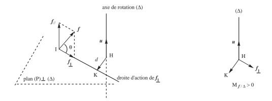
On peut également utiliser la « règle du tire-bouchon » : on tourne de HK à  $\vec{f}_{\perp}$  en supposant qu'on tient un tire-bouchon. Si la rotation entraine un déplacement du tire-bouchon dans le sens de  $\vec{u}$ , le moment est positif, sinon il est négatif.
