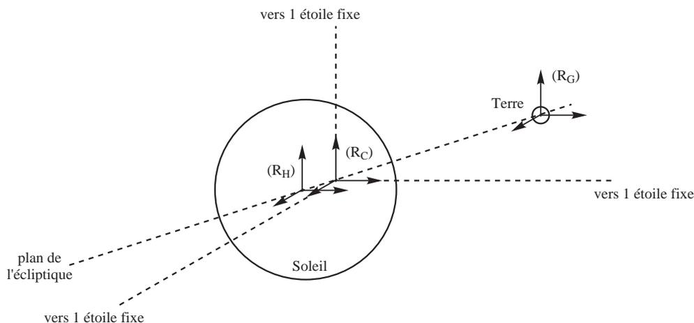
Sur ces schémas, on a choisi des axes quelconques par rapport au plan de l'écliptique. On peut néanmoins s'arranger pour que deux d'entre eux soient dans le plan de l'écliptique.
