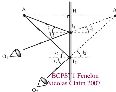
D'après la loi de Snell-Descartes pour la réflexion, les angles incident et réfléchi sont égaux. Il est évident sur la figure que la droite  $(O_1I_1)$  est symétrique de la droite  $(AI_1)$  par rapport au miroir. De même, la droite  $(O_2I_2)$  est symétrique de la droite  $(AI_2)$  par rapport au miroir. Les deux rayons réfléchis se coupent en un point  $A'$  symétrique de A par rapport au miroir. Le point  $A'$  est l'image du point A par le miroir.
