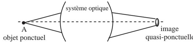
On peut noter qu'il est souvent suffisant d'avoir un stigmatisme approché. En effet, dans le cas où le système n'est pas stigmatique, l'image d'un objet ponctuel est une tache étendue (non ponctuelle). Tant que la largeur de cette tache reste inférieure à la taille du récepteur (une cellule oculaire, un grain de la pellicule photographique, etc), l'image apparaît ponctuelle.
