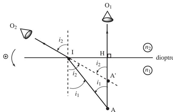
Un rayon issu de l'objet  $A$  et arrivant sur le dioptré avec une incidence  $i_1$  est réfracté selon un angle  $i_2$  obéissant à la loi de Descartes :
