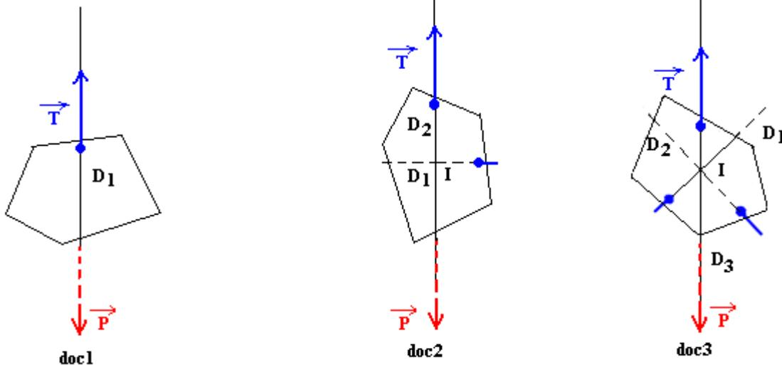
Remarquons que le centre de gravité d'un corps peut très bien se trouver en dehors de ce corps. Exemples: centre de gravité d'une chaise ou encore celui du sauteur en hauteur dont le centre de gravité passe sous la barre.
