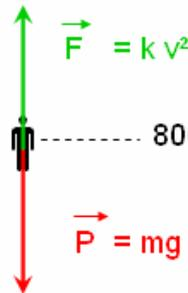
Instant où la vitesse fait que la force de frottement due à l'air est égale à la force due au poids.... ET la vitesse du parachutiste devient constante....
