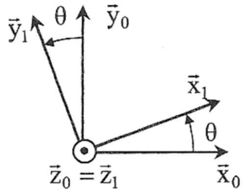
De la même façon, on obtient la figure plane de changement de base entre (B2) et (B1) :
