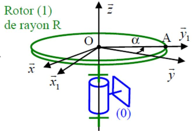
Le rotor (1) est animé d'un mouvement de rotation par rapport au bâti (0).
