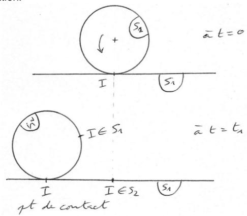
On a  $\vec{V}(I \in S2/S1) = \vec{0}$  , mais le point I se déplace (point géométrique de contact ).
