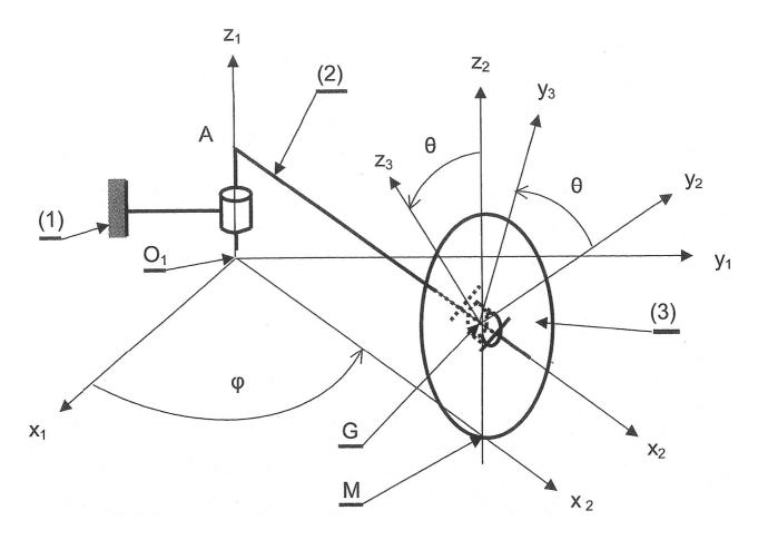
Question : Déterminer la relation entre  $\theta$  et  $\phi$  lorsqu'on a roulement sans glissement en M.
