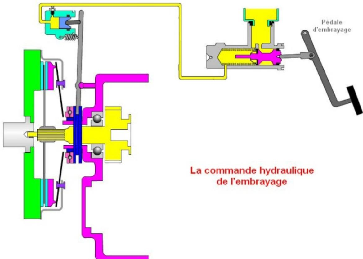
La chaîne fonctionnelle ci-dessous présente les différents constituants d'un embrayage à commande hydraulique.
