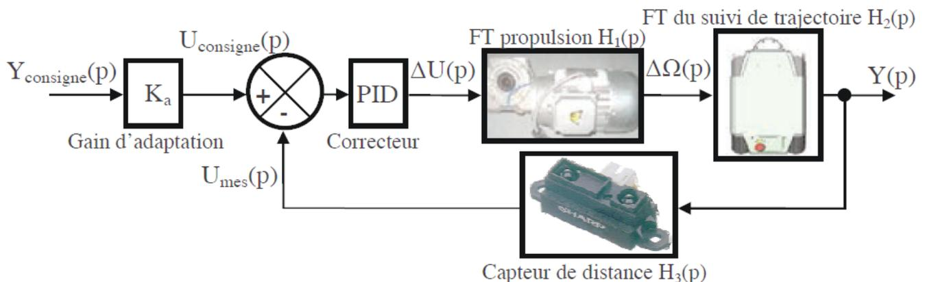
Le comportement du groupe de propulsion se caractérise par 3 fonctions de transfert successives :  $H_1(p)$  du groupe de propulsion,  $H_2(p)$  du suivi de la trajectoire et  $H_3(p)$  du bloc « capteur de distance ».
