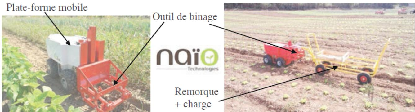
Ce robot est constitué d'une plate-forme mobile électrique à 4 roues motrices sur laquelle sont fixés divers outils et capteurs. On souhaite valider le comportement du robot vis-à-vis du critère de précision lorsqu'il suit une allée de culture. On s'intéresse donc à l'asservissement de position du robot suivant la ligne moyenne à suivre dans l'allée.
