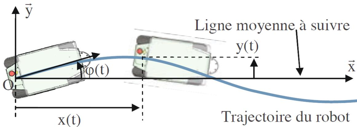
La variable  $y(t)$  correspond à la distance d'un point particulier du robot par rapport à la ligne moyenne dans le rang de culture. Le modèle de l'asservissement de suivi de l'allée du robot est donné par le schéma-bloc suivant :
