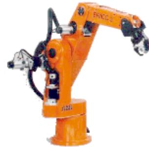
Dans ce type de mécanisme les paramètres cinématiques sont tous indépendants, il faut donc piloter chaque paramètre cinématique.
