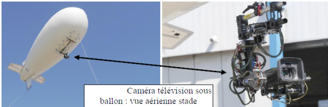
Ce sujet concerne un stabilisateur actif, on s'intéresse au support de la caméra (appareil photo) assurant la liaison entre le système de mise en mouvement appelé porteur (poignée - câble - hélicoptère - bras) et la caméra elle-même.
