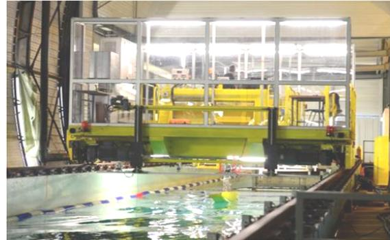
Ce bassin permet de mener des études de navires sur eau calme et sur houle afin d'optimiser les carènes, la tenue à la mer de navires ou structures flottantes.
