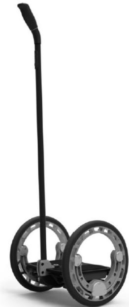
Chaque roue possède sa propre motorisation constituée d'une machine synchrone avec autopilotage permettant de s'affranchir de l'utilisation d'un réducteur. La transmission se résume à un galet directement lié à l'arbre moteur entraînant la roue.
