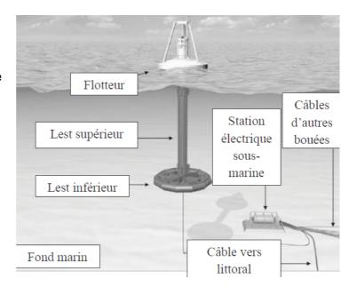
Ce système d'absorption d'énergie est constitué de deux principaux sous-ensembles :
