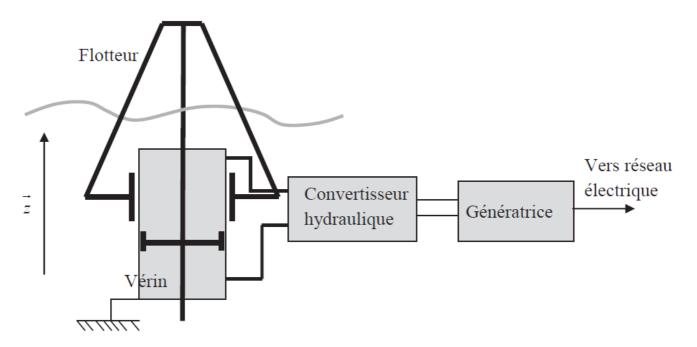
Le mouvement de la houle provoque le déplacement du flotteur par rapport au lest.
