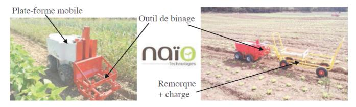
Ce robot est constitué d'une plate-forme mobile électrique à 4 roues motrices sur laquelle sont fixés divers outils et capteurs.
