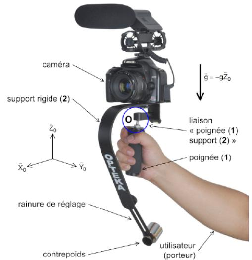
On donne ci-dessous le schéma cinématique simplifié d'un stabilisateur mécanique.
