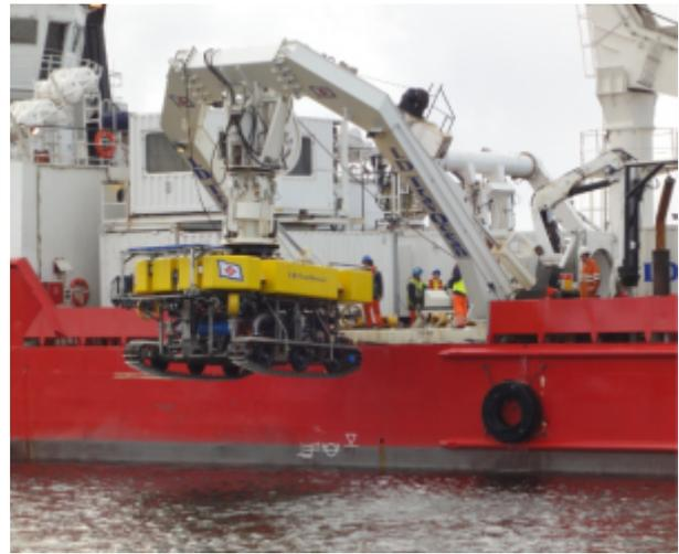
**Figure 3** ROV suspendu à la grue portique
