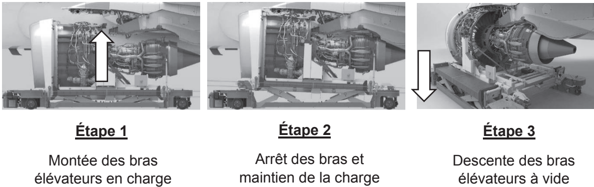
Figure 5 - Étapes pour la pose d'un moteur
