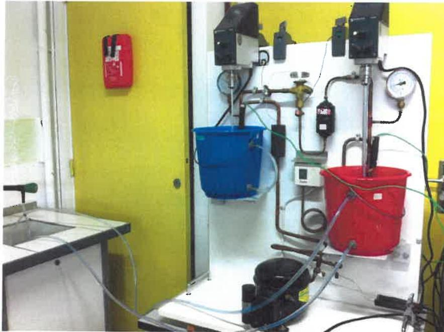
Figure 8 Pompe à chaleur avec dispositif de refroidissement
