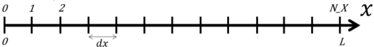
**Figure 3 -** Discretisation de l'isolant selon  $x$
