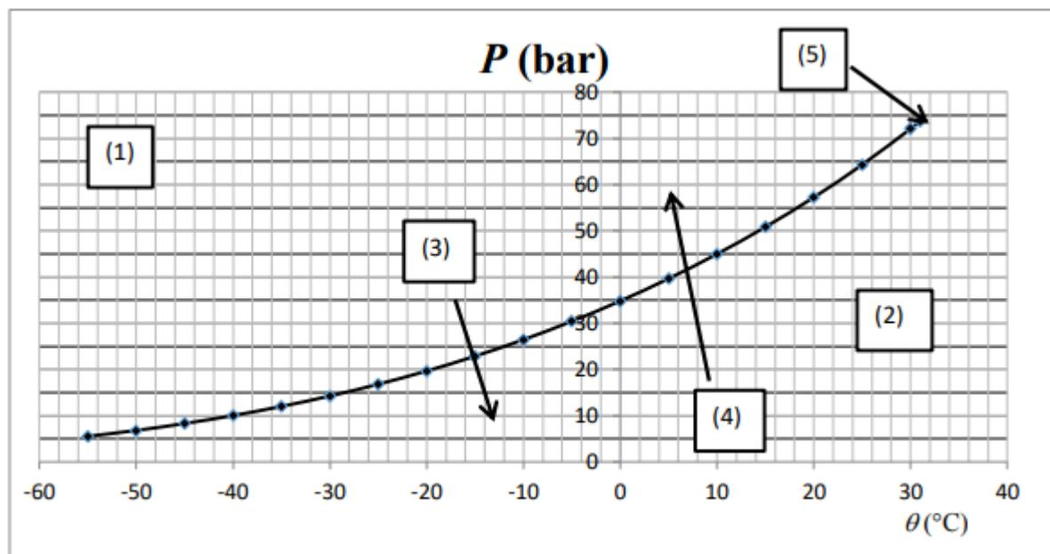
**Figure 3 - Courbe d'équilibre liquide - vapeur pour CO<sub>2</sub>**
