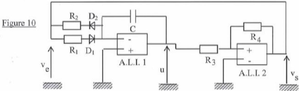
Les amplificateurs linéaires intégrés (A.L.I.) sont supposés idéaux. Ils sont alimentés par des tensions continues  $\pm V_0$  avec  $V_0 = 15 \text{ V}$ , et on suppose que leur tension de saturation est :  $V_{\text{sat}} = V_0$ .
