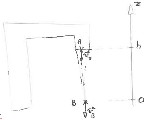
L'écoulement de l'eau est homogène et incompressible, donc le débit volumique, sur une même ligne de courant, se conserve.
