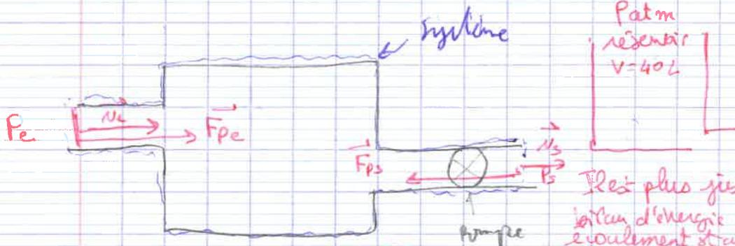
et montre  $Dm [(e_{cs} - e_{ce}) + (e_{ps} - e_{pe})] = P_{pression} + P_{visco} + P_{pompe}$
