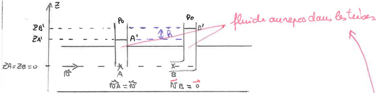
L'écoulement est stationnaire, homogène, parfait, incompressible et sans machine.
