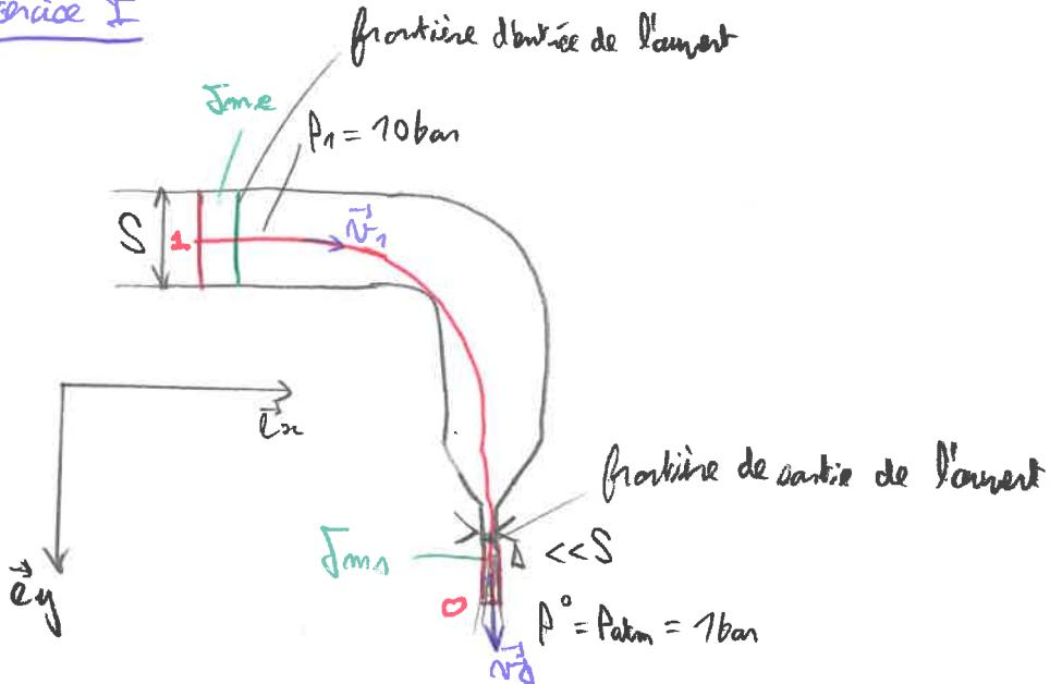
l'eau est en écoulement stationnaire, parfait, incompressible et homogène dans le tuyau. On peut donc utiliser la relation de Bernoulli pour trouver  $\vec{V}_0$ , la vitesse du jet en sortie de la lance.
