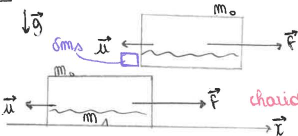
$$\begin{aligned} &\text{chariot à } t+dt \text{ de masse } m(t+dt) \\ &= m(t) - dm \\ &= m(t) - Dm t \end{aligned}$$
