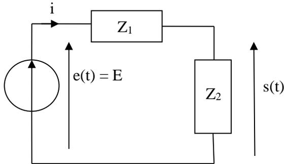
$Z_1$  association série d'une bobine parfaite d'inductance  $L$  et d'un condensateur parfait de capacité  $C$  ;  $Z_2 = R$
