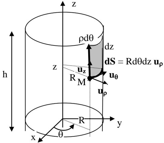
Surface latérale d'un cylindre de rayon R et de hauteur h
