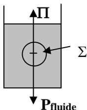
Soit la partie  $\Sigma$  du fluide en équilibre sous l'effet de son poids  $\vec{P}$  et des forces de pression exercées par le fluide.
