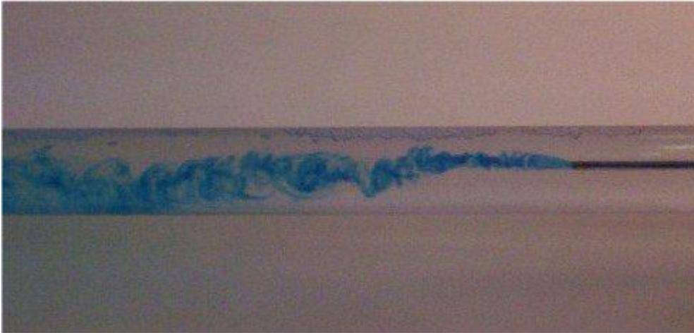
Les **expériences** réalisées par **Reynolds** (1883) lors de l'écoulement d'un fluide dans une conduite cylindrique rectiligne, ont montré l'existence de deux régimes d'écoulement : **laminaire et turbulent**.
