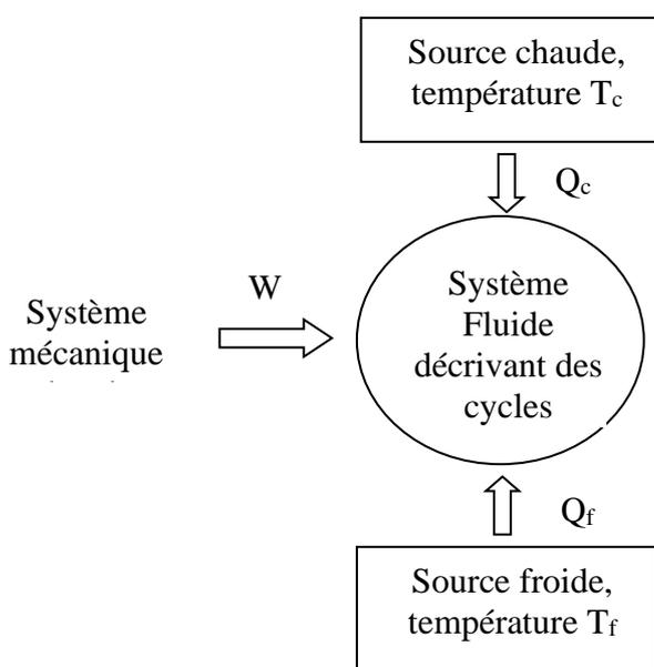
On symbolise par le diagramme ci- contre le principe de fonctionnement d'une machine cyclique ditherme :
