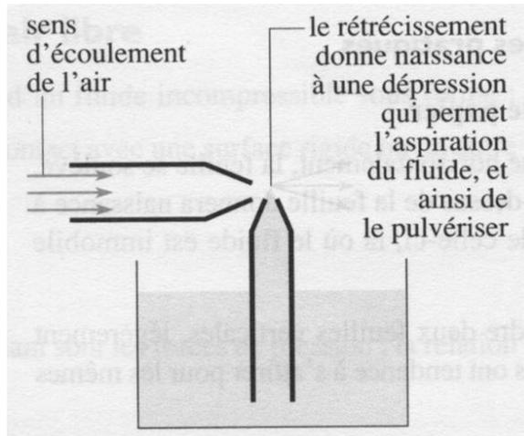
**Doc. 29.** Principe de fonctionnement d'un vaporisateur, ou d'un pistolet à peinture.
