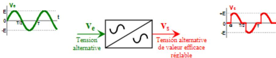
Variateur des ampoules halogènes
