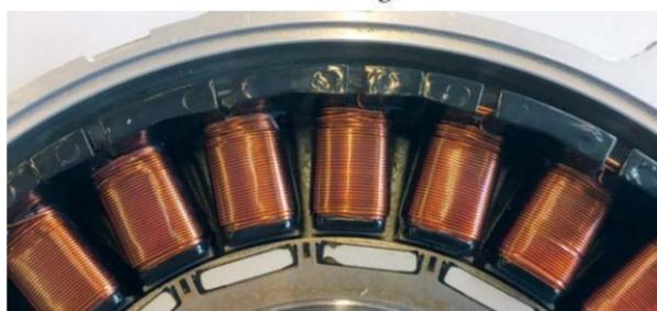
Les bobinages constituant le stator sont soit répartis (comme à gauche), soit concentrés (comme à droites). Les bobinages répartis sont mieux adaptés aux machines tournant à grande vitesse. Presque tous les moteurs électriques puissants sont à bobinages répartis. Ceux qui sont particulièrement compacts mettent en œuvre des fils conducteurs à section carrée (en haut), forme qui permet de mieux occuper l'espace.
