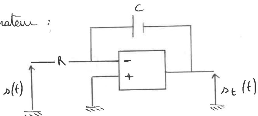
avec  $R = 1 \text{ k}\Omega$  et  $C = 1 \text{nF}$  par exemple
