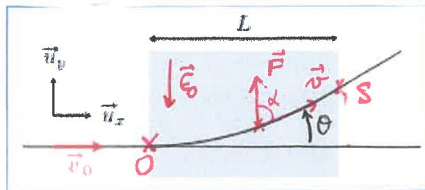
1. L'électron rentre dans une zone où le champ électrique est uniforme  $\vec{E}_0$
