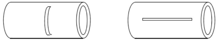
a) Fissuration orthoradiale
