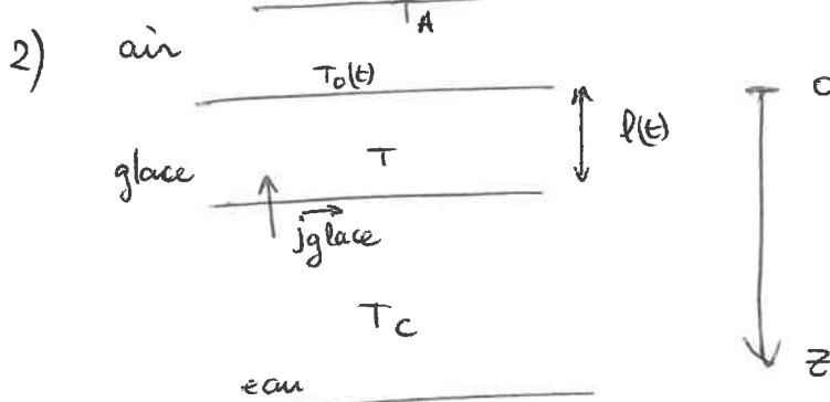
L'eau, l'air et la glace sont traversés par la même puissance thermique et non pas la même différence de température donc ils peuvent être associés en série. ]III
