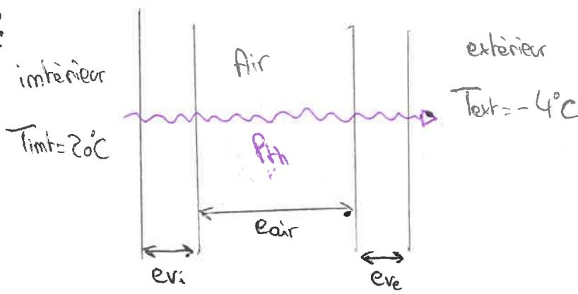
$$\text{De même, } \star R_{th\ cint} = \frac{1}{h_i \cdot L_v \cdot h_v} = \frac{1}{8 \cdot (2000 + 840) \cdot 10^3} = 0,044 \text{ k-W}^{-1} \quad \approx 0,014 \text{ k-W}^{-1}$$
