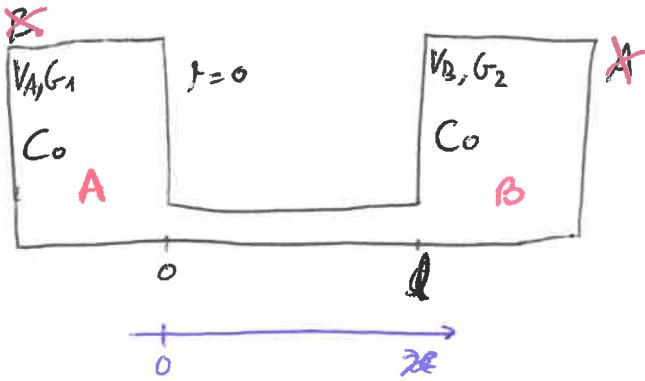
1- si  $\alpha > 0$ ,  $G_1$  va se propager dans le tube pour aller vers B jusqu'à atteindre une concentration  $\frac{C_0}{2}$  dans A et B, réciproquement pour  $G_2$  qui va de B vers A
