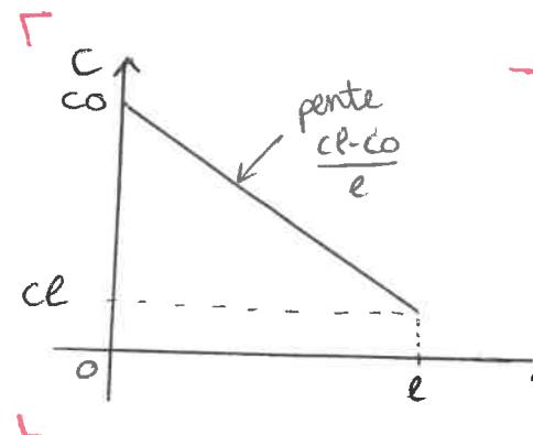
grâce à la loi de Fick:  $jN = -D \frac{\partial C}{\partial n} = -D \frac{Cl - C_0}{l}$
