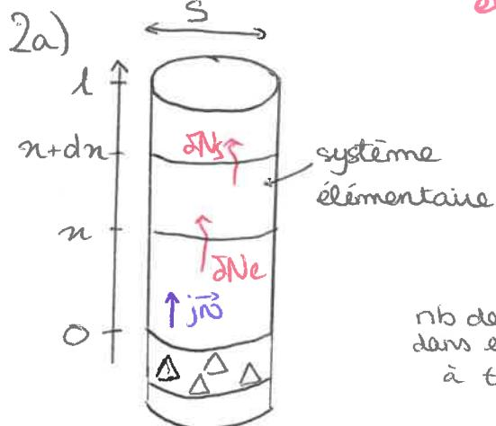
bilan de particule dans le système élémentaire situé entre  $n$  et  $n+dn$
