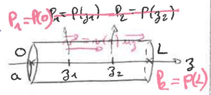
2)  $v_z(a) = 0$  car elle représente la vitesse à l'interface solide-fluide. Et d'après la condition d'adhérence fluide-solide, on a bien  $v_z(a) = 0$ .  $v_z(a)$  est le minimum de la fonction  $v_z(r)$ . De plus, la vitesse est maximum pour  $r = 0$ .
