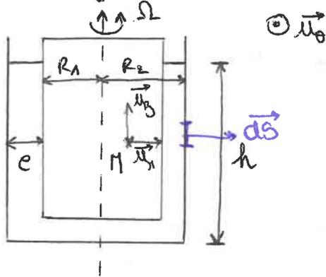
1) \* Par symétrie,  $\vec{V}(r) = V(r; \theta; z) \vec{u}_\theta$   $\rightarrow$   $\vec{V}$  colinéaire à la cause caéd la rotation des cylindres de rayon  $R_1$
