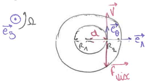
$$M_b(\vec{F}_{\text{visc}}) = -\|\vec{F}_{\text{visc}}\| r d \text{ où } d = R_1$$
