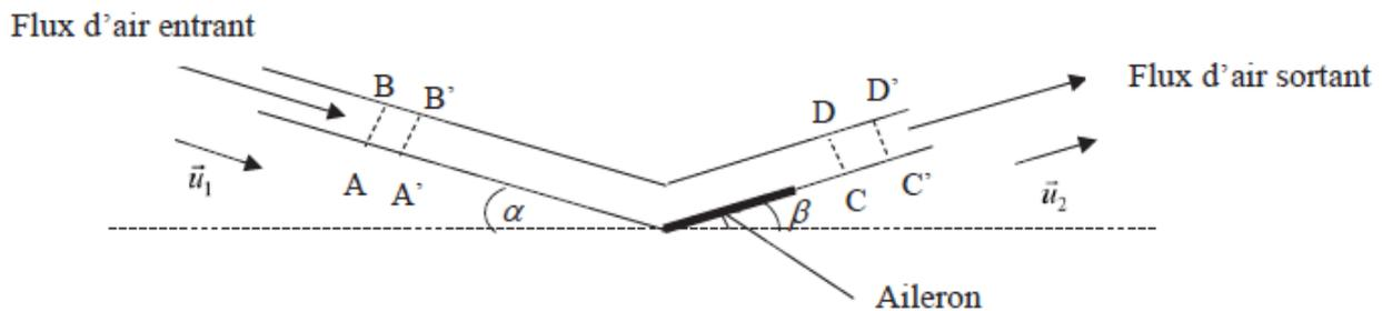
On note respectivement  $\vec{v}_1 = v_1 \vec{u}_1$  et  $\vec{v}_2 = v_2 \vec{u}_2$ , les vitesses des écoulements d'air entrant et sortant du tube de courant.  $\vec{u}_1$  et  $\vec{u}_2$  sont des vecteurs unitaires.
