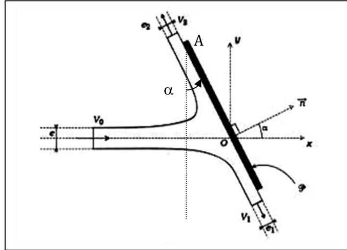
1. Déterminer les modules des vitesses  $v_1$  et  $v_2$ , à la sortie du jet.
