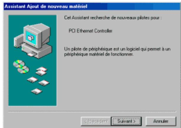
**Étape 2 :** Il suffit ici de cliquer sur le bouton "Suivant". et de suivre les indications de Windows. En général, il faut redémarrer l'unité centrale après la fin de l'installation
