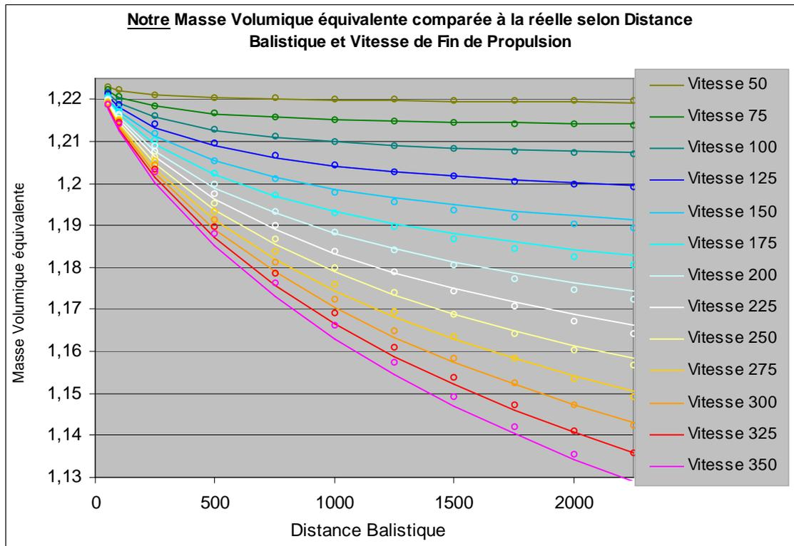
Les marques rondes représentent notre Masse Volumique Équivalente (la courbe bleue dense naissant de notre formulation en  $4,3 \cdot 10^{-5}$  propre à la vitesse **125 m/s**, et les autres naissant de notre formulation en  $4,52 \cdot 10^{-5}$  propre aux vitesses de **150 à 300 m/s**).
