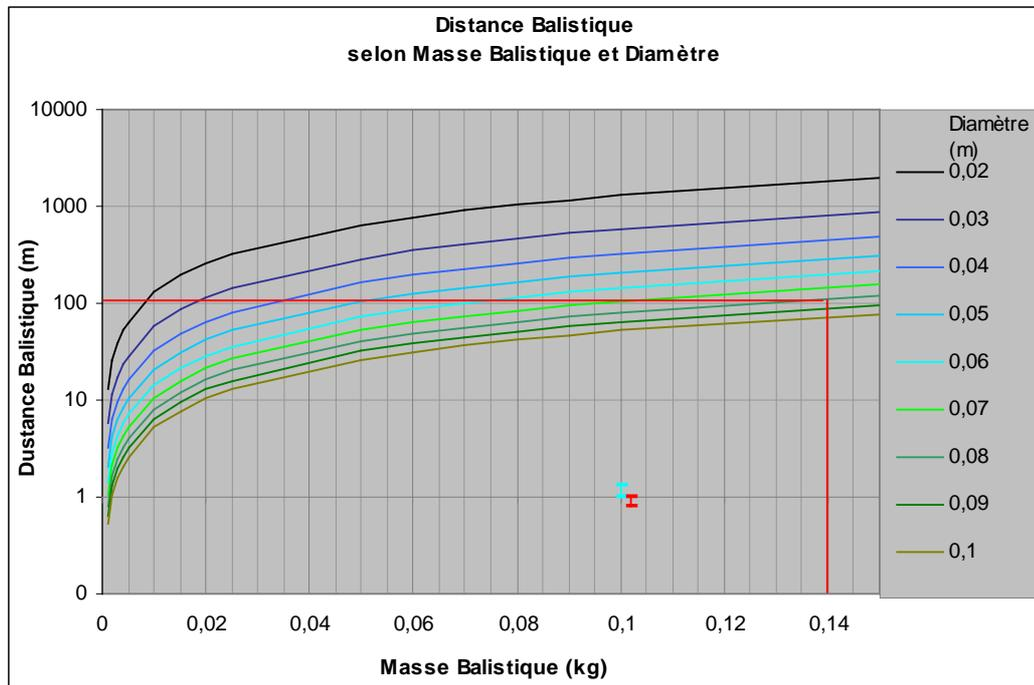
La construction rouge prédit par exemple à une fusée à eau de **140 g** et **80 mm** de diamètre une Distance balistique d'un peu plus de **100 m** (pour un **Cx** de **0,4**).
