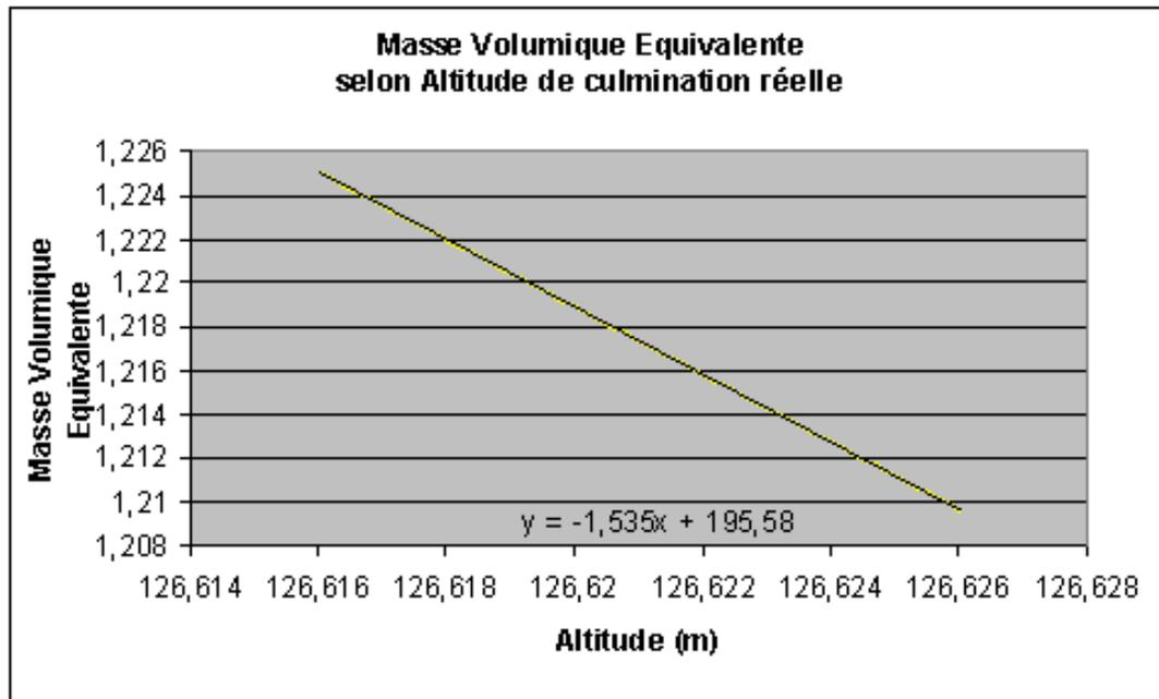
L'influence de l'Altitude sur la Masse Volumique Équivalente est ici extrêmement forte : une erreur de **1 m** sur le calcul de l'Altitude de Culmination (qui la ferait passer de **126,614** à **127,614 m**) rendrait la Masse Volumique Équivalente négative : répétons qu'en effet cette Masse Volumique est très peu influente (freinante) et que pour gagner de l'altitude en jouant uniquement sur la Masse Volumique il faut annuler complètement celle-ci !
