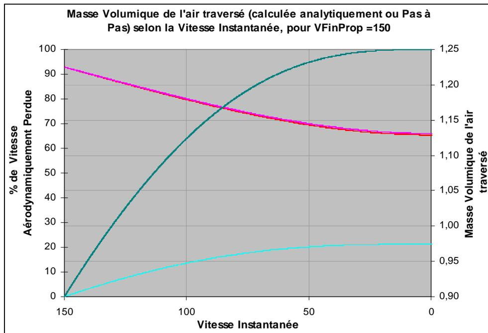
On doit noter que la part du capital de vitesse perdu en Traînée Aérodynamique est beaucoup plus faible (**21 %**) et que cette perte est acquise plus tôt durant le vol (**83 %** à une vitesse moitié de celle de Fin de Propulsion), c-à-d que les variations de Masse Volumique Aérienne se feront encore moins sentir que pour le modèle de vol précédent...
