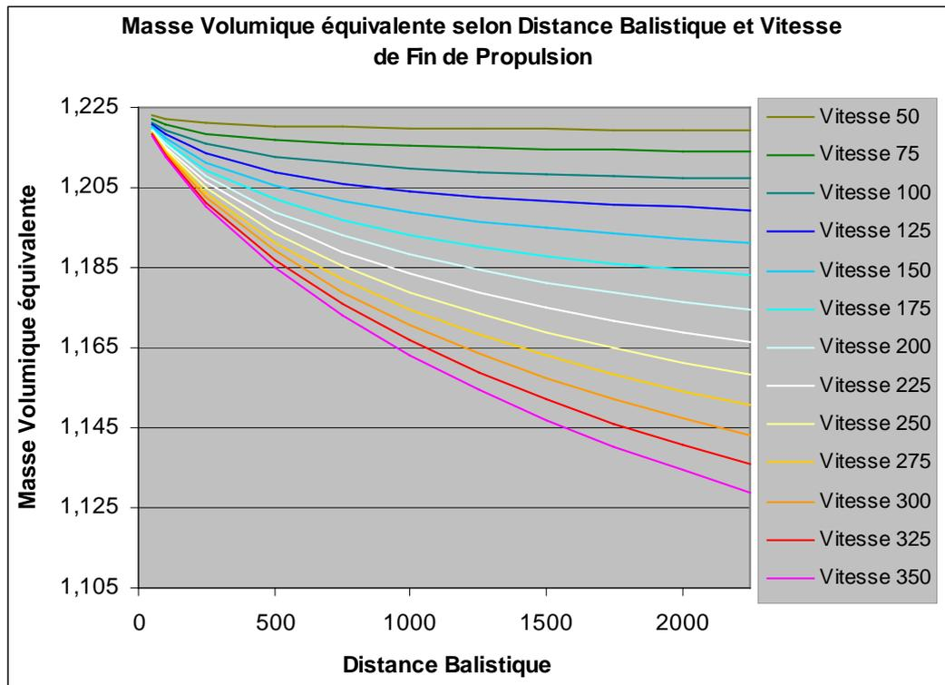
Comme on pouvait s'y attendre, à Vitesse de Projection égale <sup>28</sup>, la Masse Volumique Équivalente diminue à mesure qu'augmentent les capacités de pénétration de la fusée (sa Distance Balistique) puisqu'alors la fusée traverse des couches d'air de Masse Volumique diminuées par l'altitude.
