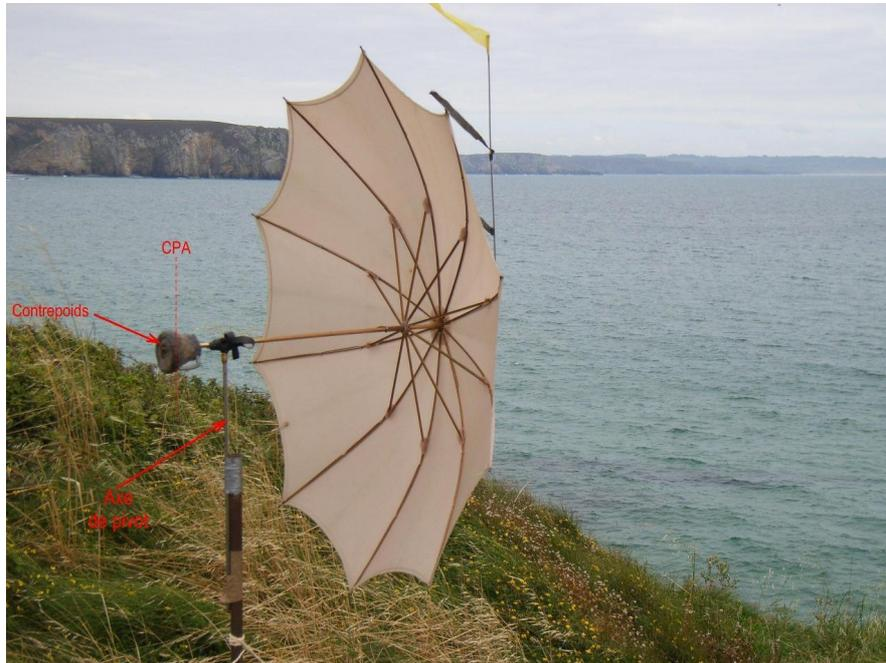
Cette photographie de l'expérience montre la calotte sphérique du parapluie libre de tourner autour d'un pivot. Dans cette brise bien établie, ce corps, dont la surface est pourtant très en avant de l'axe de pivot, reste stable face au vent sur une grande plage angulaire (plus de  $45^\circ$  d'angle de part et d'autre, de mémoire).
