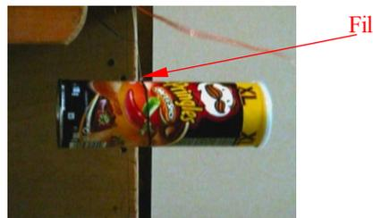
À **1,28 calibres**, ce corps est encore stable pour les petits angles d'incidence, mais les turbulences de notre soufflerie ne tardent pas à le chasser de cette zone de stabilité pour le mettre en travers...
